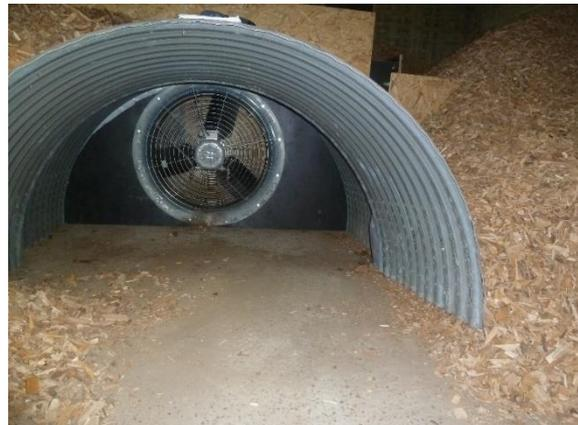
L'expérience a montré qu'il semble inutile de faire fonctionner le ventilateur en permanence. Il est mis en route seulement lorsque l'air extérieur est assez sec et quand le tas commence à chauffer. Il interrompt ainsi le processus de compostage.
