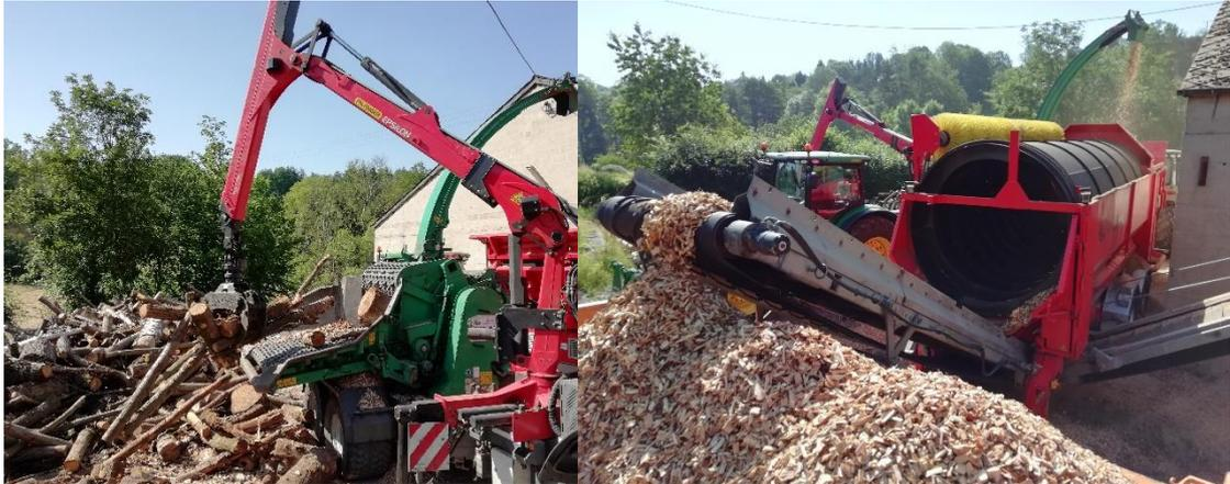
Pour des chaudières de relative moyenne puissance (100kW comme à la Pichelotte), le risque de ne pas cribler peut sembler inconsidéré si le producteur n'est pas le consommateur : Risque de blocage de la vis d'alimentation, risque de combustion incomplète... Qui assume le risque ? A long terme, est-ce rendre service à l'environnement, à la durabilité des chaufferies bois, à leur réputation ?
