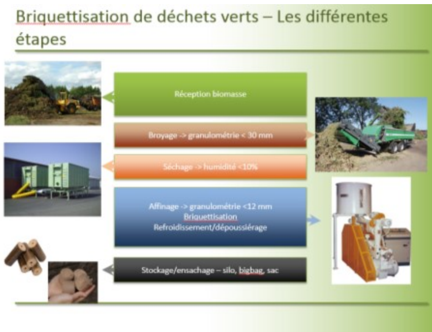
Conversion des déchets verts en briquettes - source Enerbio
